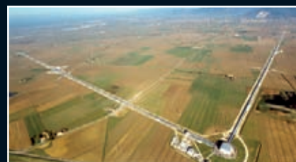
Virgo. Pour détecter les ondes gravitationnelles, la France et l'Italie ont construit, près de Pise, un interféromètre optique à laser, comportant deux bras perpendiculaires de 3 km de long.
