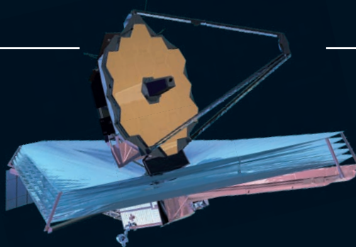
JWST (James Webb Space Telescope). Doté d'un miroir de 6,5 m de diamètre, le successeur du télescope spatial Hubble opérera dans l'infrarouge.
