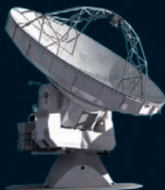
ALMA (Atacama Large Millimeter Array). Pour étudier les sources célestes d'ondes radio submillimétriques, un grand réseau de 64 antennes de 12 m de diamètre est en construction dans le désert d'Atacama, au Chili.
