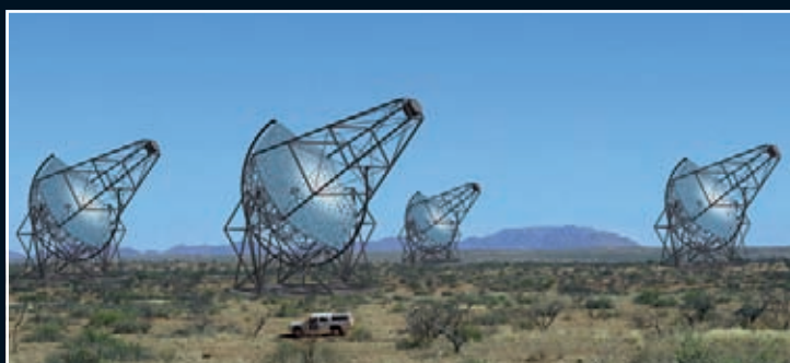
HESS (High Energy Stereoscopic System). Un réseau de 4 télescopes de 13 m de diamètre, installé en Namibie, constitue le détecteur le plus sensible au monde de rayonnement \gamma de très haute énergie d'origine cosmique.
